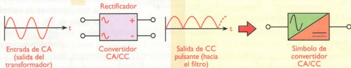
Figura 7.6. Acción básica del rectificador en una fuente de alimentación
